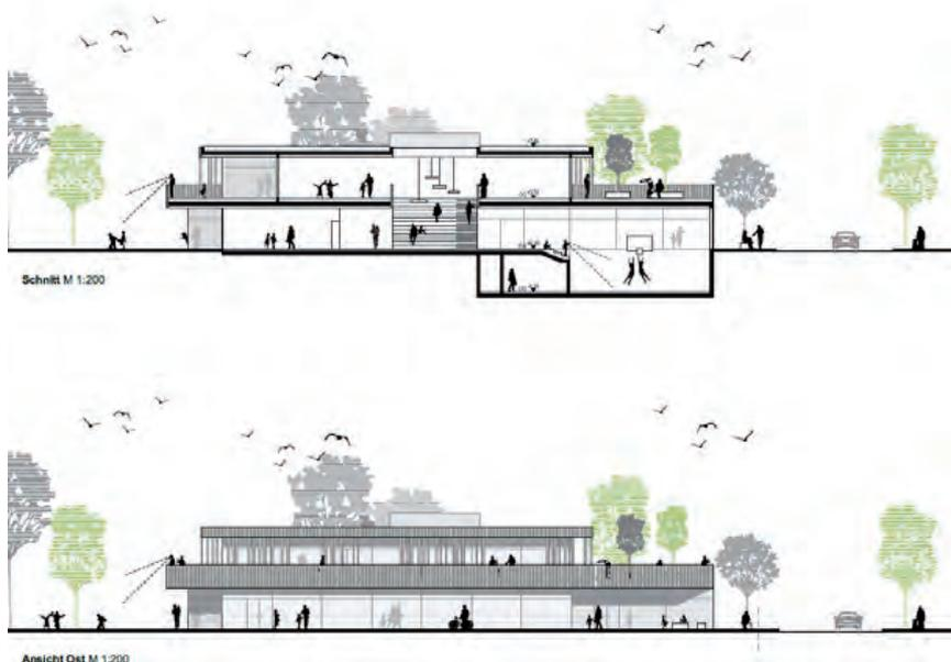
Die Konstruktion des Schulneubaus ist als Stahlbeton-Skelettbau konzipiert. Die Raumteilungen erfolgen dabei nichttragend und sorgen somit für eine langfristige Flexibilität und für eine mögliche Umstrukturierung im Innenraum. Die Fassade besteht aus hochwärmedämmten Stahlbetonwänden mit vorgehängten Holzlamellen, die mit Fenster- und Türelementen mit 3-fach-Verglasung kombiniert werden. Die
